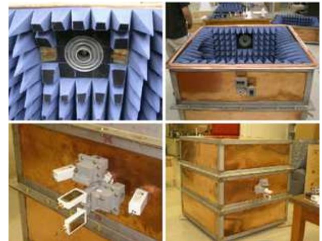
電波暗箱の中で電波計測
